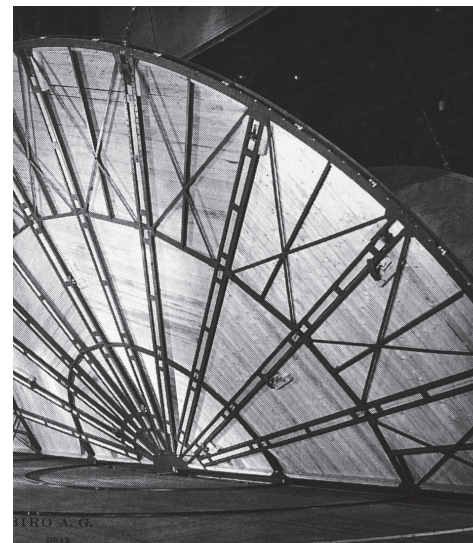
Eine vormontierte, klappbare Drehscheibe wie diese wäre eine optimale Lösung © Waagner-Biro Stage Systems / Lois Lammerhuber
